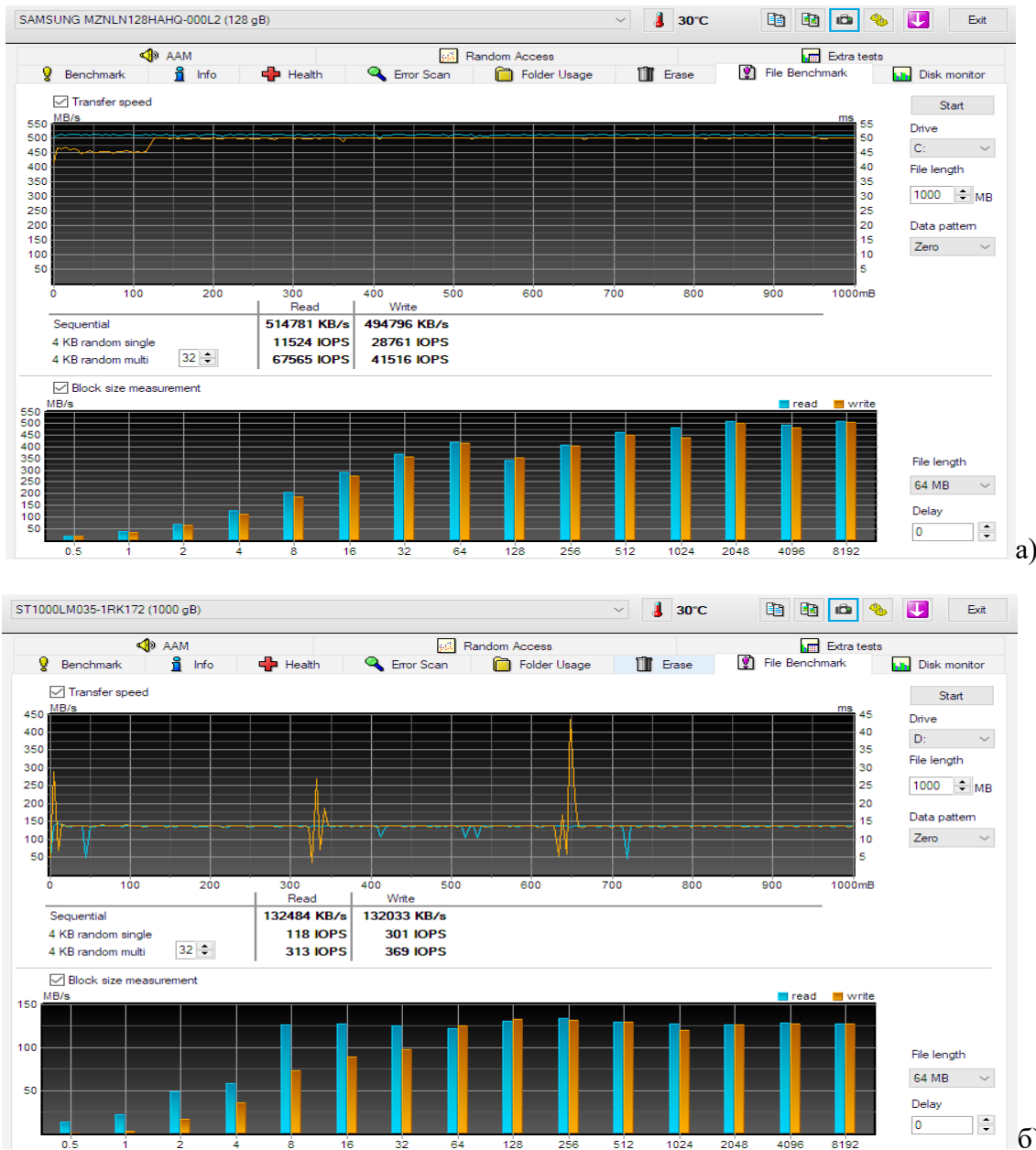
Фиг. 8. File Benchmark на а) SSD и б) HDD
